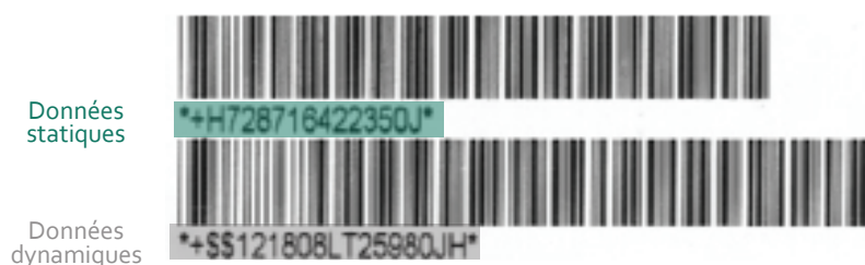
Figure 8 : Code-barres scindé en deux parties (dans cet exemple, la partie dynamique contient la date d'expiration au format MMAA suivie du numéro de lot)
