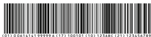
Figure 3 : Code-barres linéaire GS1 (dans cet exemple, sont successivement symbolisés la partie statique puis la date d'expiration au format AAMMJJ, le numéro de lot et le numéro de série)
